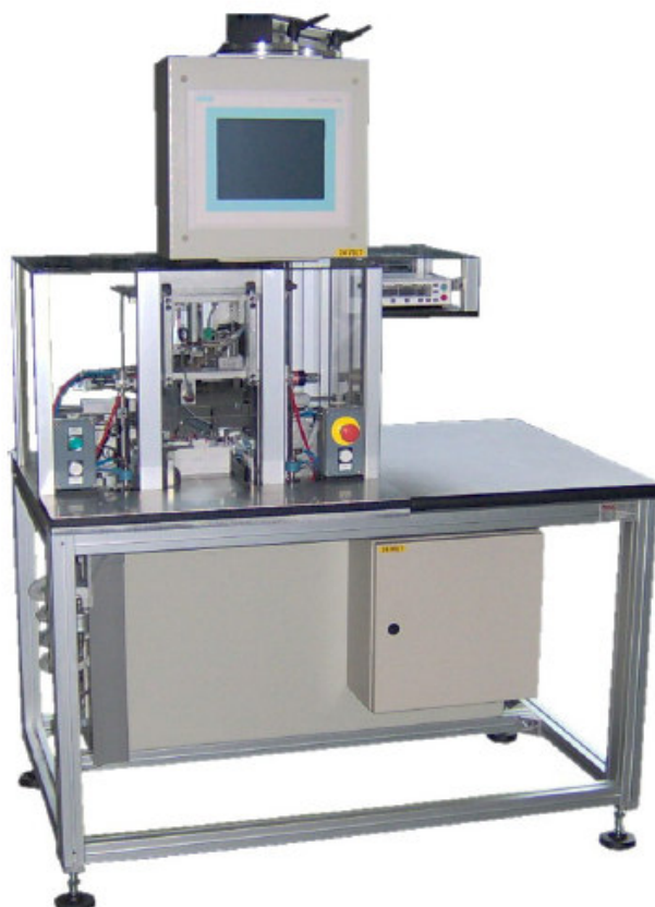
Esempio tipico di un'apparecchiatura dedicata al collaudo in automatico di interruttori magnetotermici.
